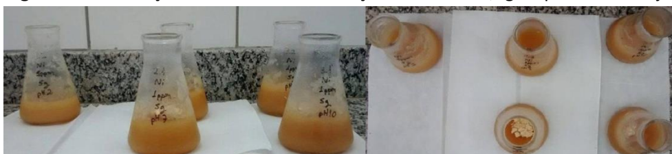
Figura 6. Geleificação nas amostras da solução de Ni com 5,0g de pó de maracujá.
