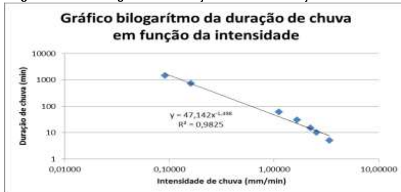
Figura 4: Gráfico bilogarítimo da duração da chuva em função da intensidade
