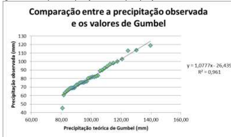
Figura 3 Gráfico para comparação entre as precipitações observada e de Gumbel.
