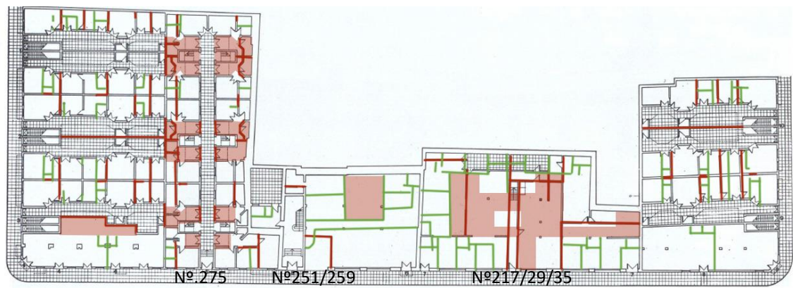
Figura 5 - Planta térrea (demolição e construção da reabilitação)
