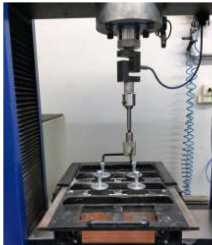
Figura 1 : Ensaio de resistência de aderência
