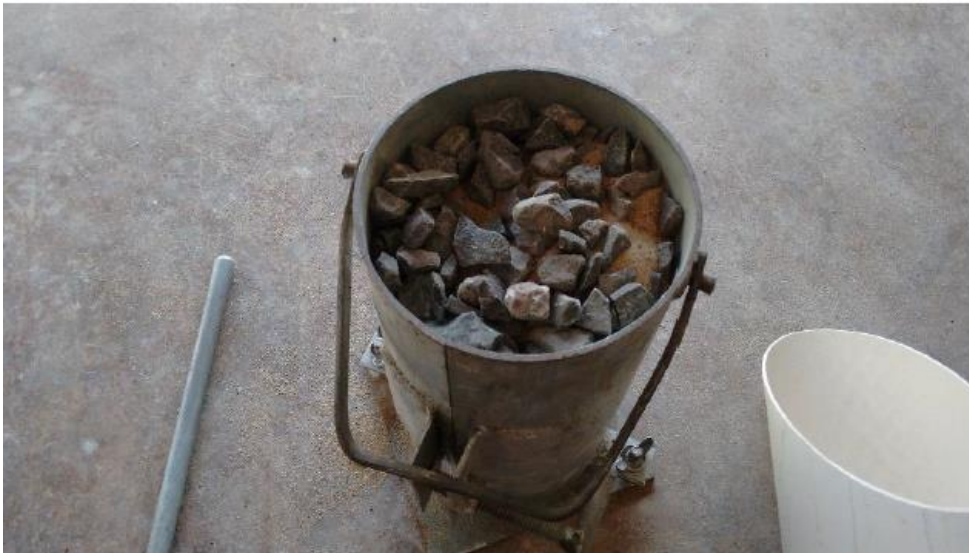
Figura 1: agregados no ensaio de massa unitária compactada
