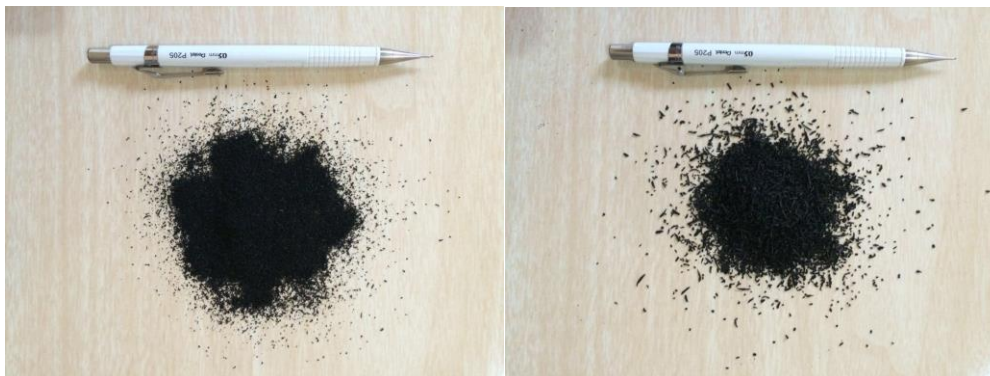
Figura 3: Granulometrias de borracha utilizadas nos compósitos de gesso
