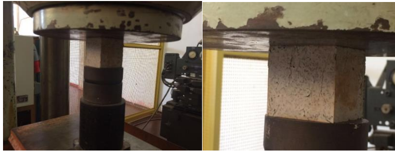
Figura 9: Ensaio de Resistência à compressão
