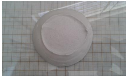
Figura 8: Ensaio de consistência dos compósitos
