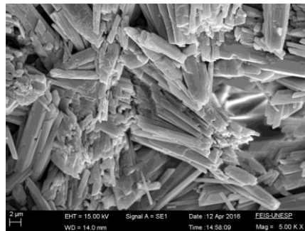
Figura 10: Cristalização do gesso na pasta controle
