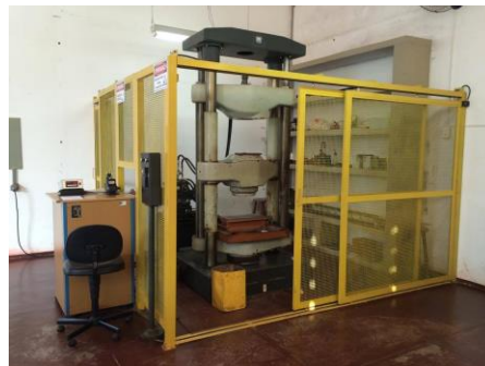
Figura 6: Prensa para ensaio de Resistência à compressão
