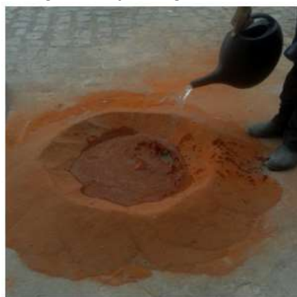
Figura 4: adição de água na mistura
