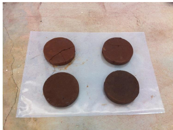
Figura 3. Corpos de provas com a adição de CCA (abaixo) e sem a adição de CCA (acima) após a realização do ensaio edométrico simples
