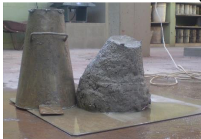
Figura 4: Ensaio de Abatimento do Tronco de Cone (Slump Test)
