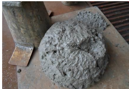
Figura 4 – Análise visual da consistência dos concretos
