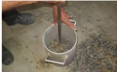
Figura 2 - Ensaio de massa unitária compactada
